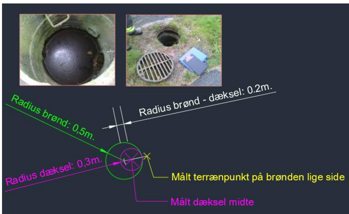
Billede 5.3 A: Indmåling af dæksel i forhold til brønd.
