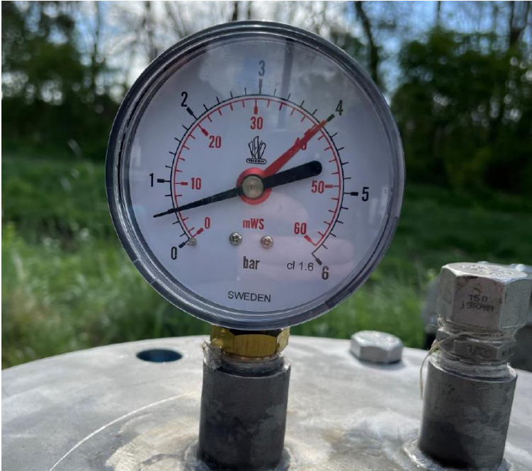
Figur 2 Trykmåler ved trykprøvning af nye indvindingsboringer.
