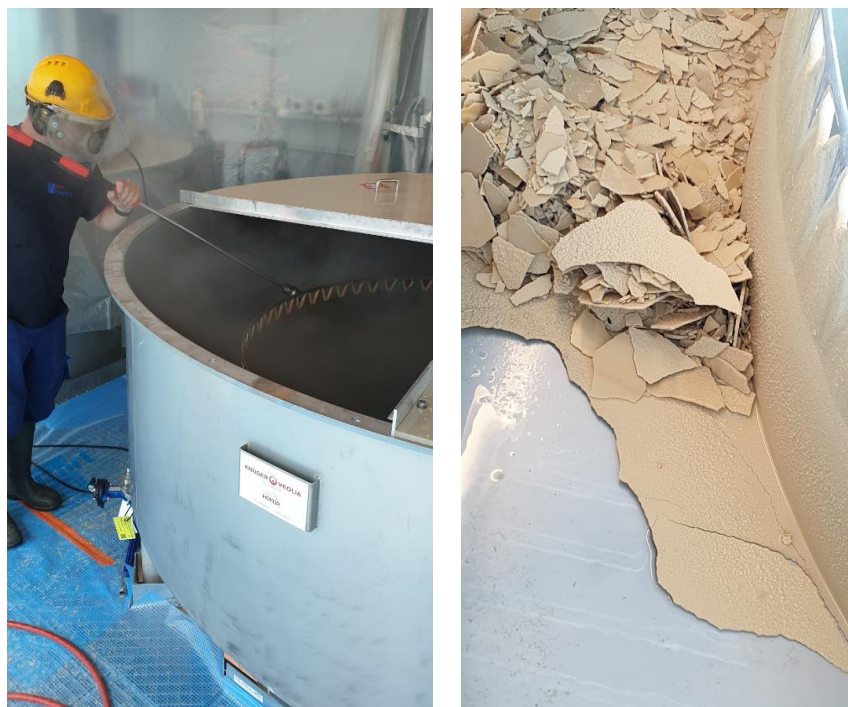
Figur 7 - (venstre) manual fjernelse af kalk i kolonnetop og overløbsrende, og (højre) effektivitet af rensningen.
