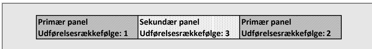
Figur 2, Slidsevæg, definitioner og udførelsesrækkefølge
