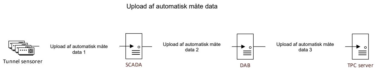
Tunnel sensorer er enten placeret i Tunnel Boring Machine (TBM) eller i tunnelrørsstrenge (tunnel pipe strings). Automatisk målte data upload i realtid til et SCADA system, som befinner sig på den lokation, hvor tunnelboringsarbejdet finder sted. Data upload til en Data Acquisition Box (DAB), som lagrer data og sender data med regelmæssige mellemrum (nær realtid) videre til TPC server.
